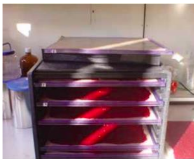
Figure 22 Séchoir électrique à plateaux pour le séchage de feuilles de figues de Barbarie
